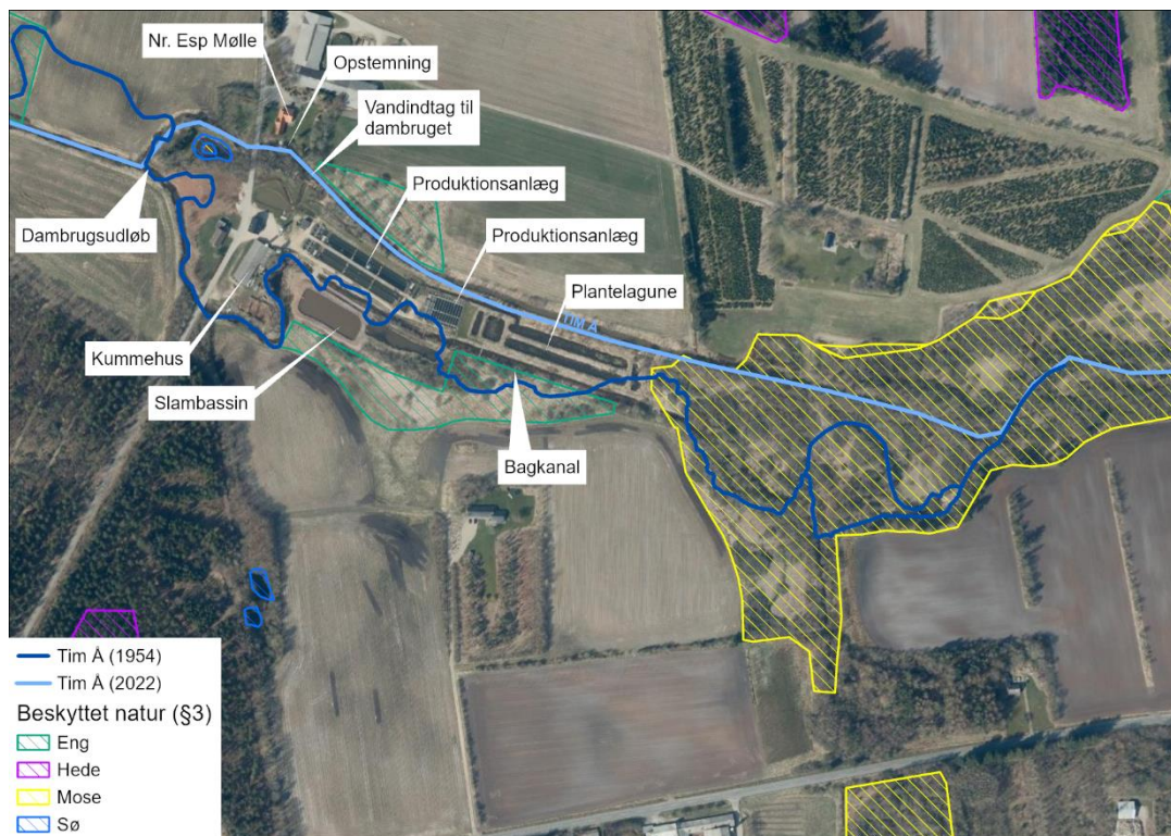
Figur 5. Forløbet af Tim Å i hhv. 1954 og i dag. I 1954 var det dog kun en mindre delstrøm, der havde dette forløb, idet størstedelen af vandføringen blev brugt til dambrugsdrift.
